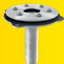
из нержавеющей стали (номер материала: 1.4301), согласно стандарту DIN EN 1253-2, для теплоизоляции толщиной 50-160 мм, с отверстиями для крепления элемента в несущей конструкции, прижимным фланцем из нержавеющей стали (номер материала: 1.4301), двумя уплотнительными манжетами для зажатия битумной, полимерной и каучуковой гидроизоляции или металлических желобов.
