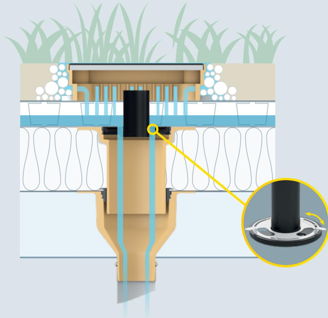
**Sita ist Überflutungs-Verhinderer.** Ungewollte Überlastungen der Kanalisation können mit geeigneten Retentionsbauteilen gesteuert werden. Oft wird eine sogenannte Einleitungsbeschränkung in die öffentliche Kanalisation von Städten und Gemeinden ausgesprochen. Um dieser zu entsprechen, muss die Niederschlagsmenge gedrosselt abgeführt werden.
