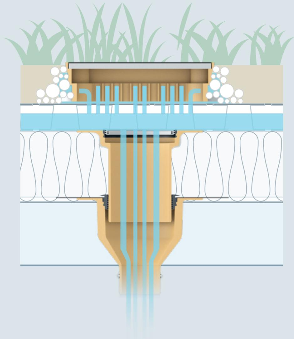
Der **SitaGreen Gründachschacht** leitet das Regenwasser sicher in die untere Entwässerungsebene ab, wo es vom SitaGully mit Aufstockelement aufgenommen und, bei Bedarf sogar zeitverzögert, in die Kanalisation weitergeleitet wird.
