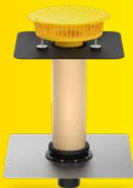
pour la protection incendie préventive et pour empêcher la propagation du feu par des petits percements de bas en haut, selon DIN 18234 parties 3 et 4. Se compose de : corps en PE, manchon d'étanchéité, tôle de renfort selon NBN EN 1090-4 avec manchon coupe-feu prémonté, élément de surélévation en PUR avec manchon de raccordement adapté et élément de retenue. Selon NBN EN 1253-2, pour l'évacuation gravitaire.
