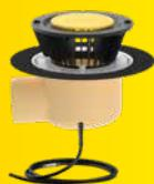
comme décrit ci-dessus, mais avec élément chauffant à réglage automatique intégré et câble de raccordement de 2,0 m de long pour 230 V, env. 10 W. Ne nécessite pas de transformateur. Inclinaison du tuyau de rallonge 3°.
