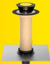
pour la protection incendie préventive et pour empêcher la propagation du feu par des petits percements de bas en haut, selon DIN 18234 parties 3 et 4. Se compose de : corps en PE, manchon d'étanchéité, tôle de renfort selon NBN EN 1090-4 avec manchon coupe-feu prémonté, élément de surélévation en PUR avec construction à bride libre ou fixe et arrêt de gravier. Selon NBN EN 1253-2, pour l'évacuation gravitaire.
