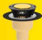
en polyuréthane, en matière isolante, selon NBN EN 1253-2, avec bride à visser pour le serrage de membranes en bitume, plastique ou caoutchouc, avec arrêt de gravier et manchons d'étanchéité.
