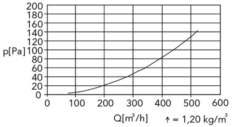
**SitaVent Systemlüfter DN 100 mit Schutzgitter**
